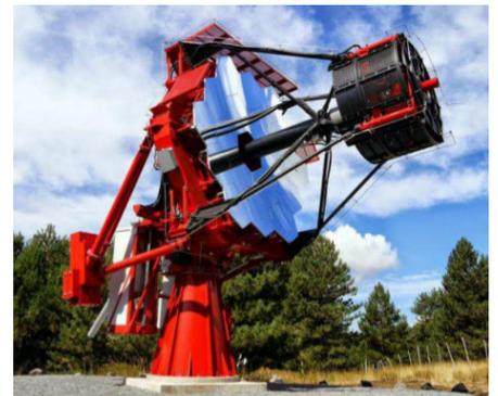
delle dimensioni rispettivamente di 23, 12 e 4 metri, per riflettere la luce Cherenkov verso una fotocamera ad alta velocità che possa digitalizzare e registrare l'immagine dello sciame. In alto: ASTRI, il prototipo di SST in Italia.
